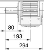
Sugestão de acoplamento no Eixo Vazado
