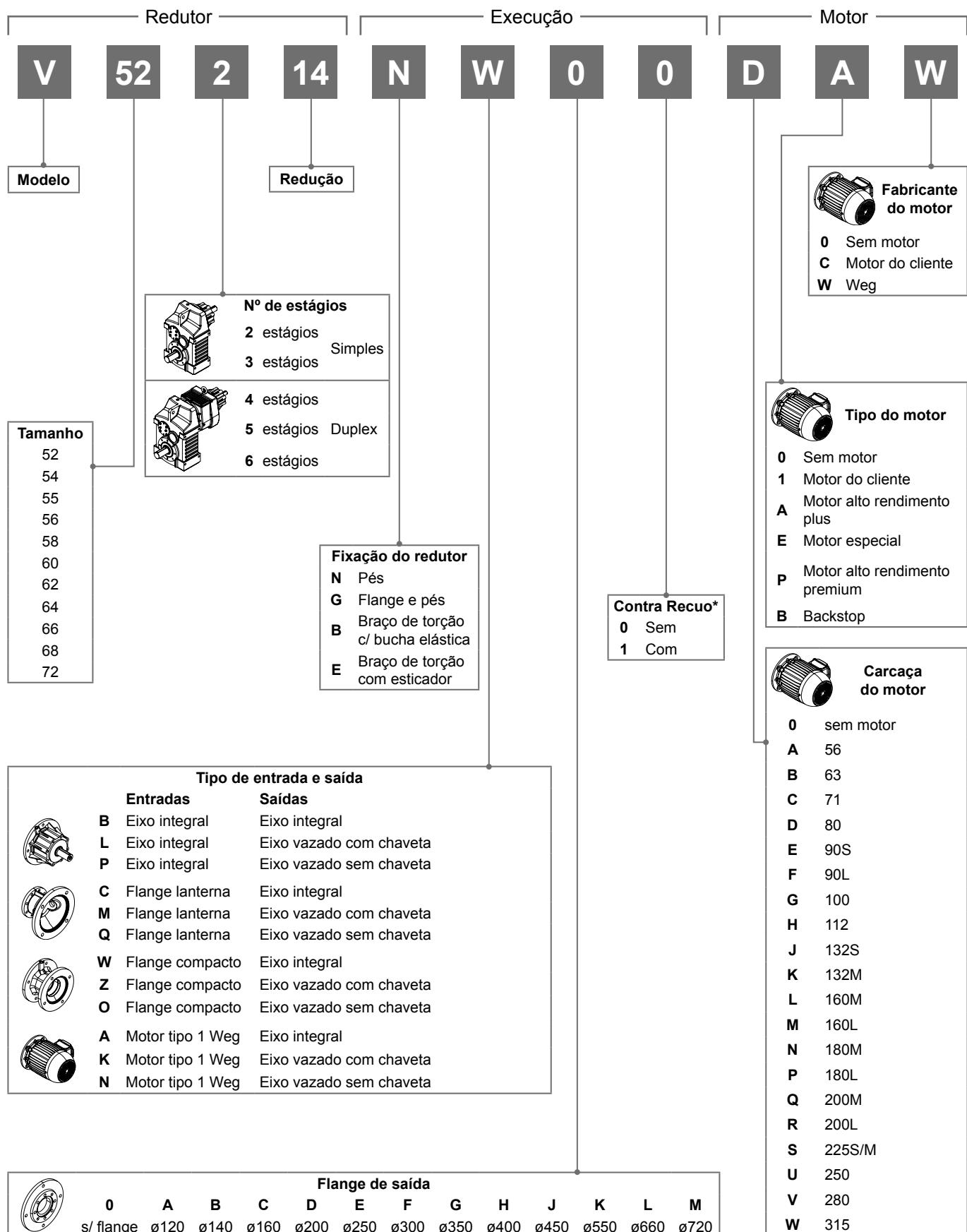
\* Para motor Weg Tipo 1, carcaças 90 até 250, o contra recuo será instalado na traseira do motor elétrico, exceto 3, 5 e 6 estágios onde é instalado dentro do redutor.
