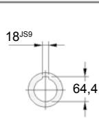
Sugestão de acoplamento no Eixo Vazado
