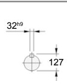
Sugestão de acoplamento no Eixo Vazado
