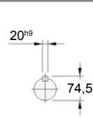
Sugestão de acoplamento no Eixo Vazado
