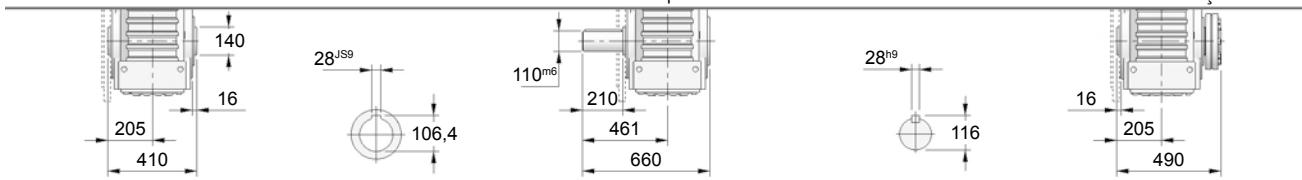
Sugestão de acoplamento no Eixo Vazado
